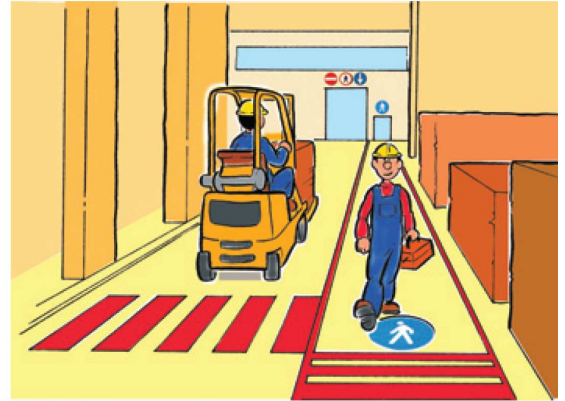
Percorsi interni di circolazione per carrelli e pedoni
